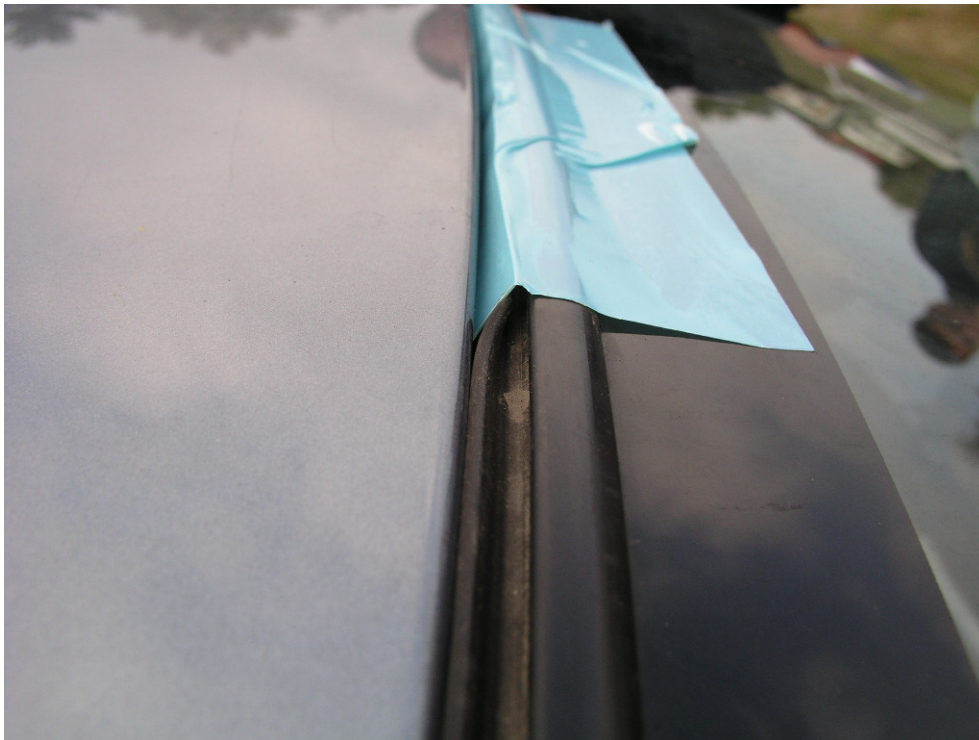
Rysunek 10 Przykład oklejania, markową taśmą 3M, szyby czołowej pojazdu do lakierowania (mieszka uszczelka, niegłębokie położenie szyby)
