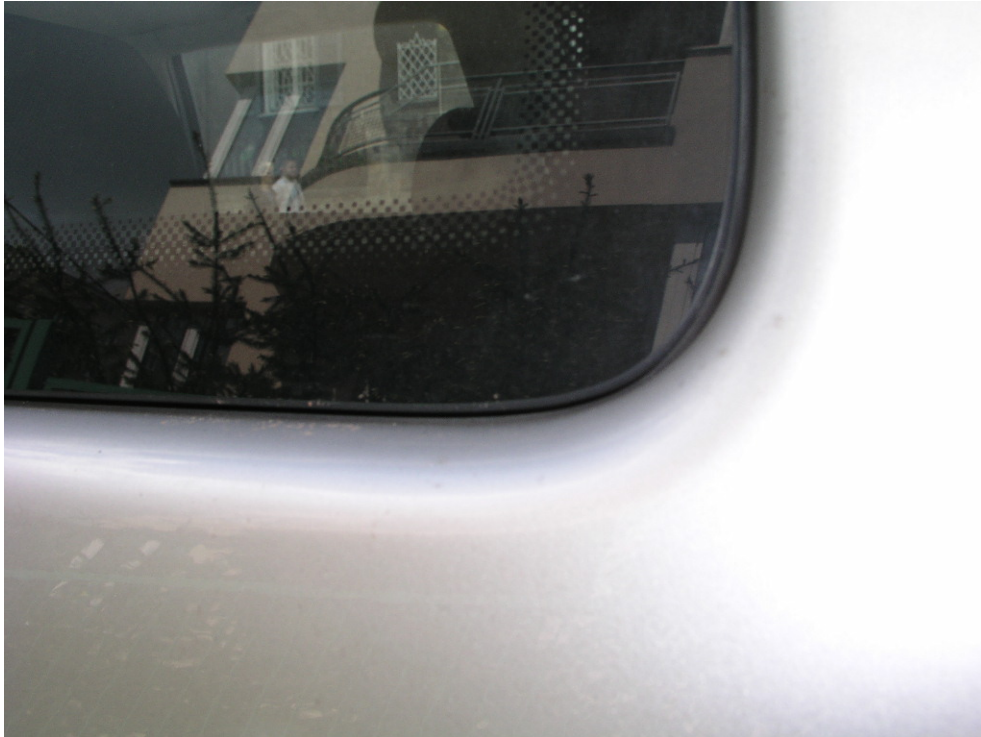
Rysunek 11 Przykład głębokiego osadzenia, twardej uszczelki, dla której skuteczne szyby do prac lakierniczych oklejenie jest niemożliwe.
